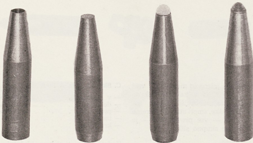
Slika 8: Z leve — telo krogle H P — ABC z vrtino, telo krogle brez vrtine, krogla s plastičnim vložkom, krogla s svinčnim vložkom 10,6 g (165 grains)
