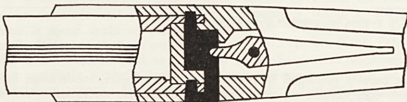
Skica 9. Dvojni prečnozatični zaklep. Prerez skozi dvojni čep
