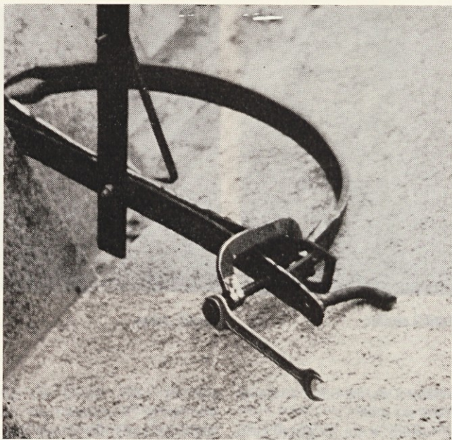
Zelo močna past dvigalka s pripravo za napenjanje, kakršne izdeluje kovač Karel Dornik v Ločici pri Polzeli
