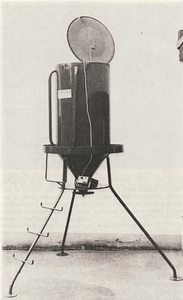
Tudi na razstavi v Dolenji vasi: R. Gorjup iz Šmarce pri Kamniku, ki sicer izdeluje znane električne pastirje »Herkules — Elektronik«, je predstavil avtomatski krmilni silos. Napravo je možno programirati tako, da vsak dan ob določeni uri raztrosi v krogu premera 20 m željeno količino zrnatih hrane.
