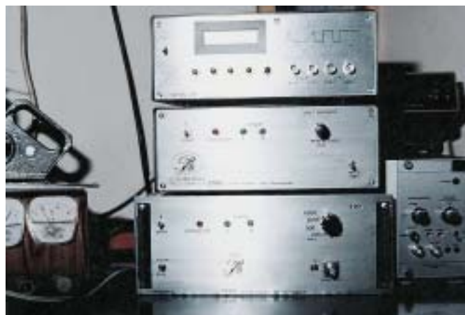
V sodobni elektroniki se skriva marsikaj. Na vrhu je viden simulator strela, pod njim pa sta merilec naboja in hitrosti. Tak način merilnega sistema je bil prikazan CIP-u in nato uzakonjen kot njihov merilni sistem. Vse to je plod razvoja družine Bratina in slovenske miselnosti.
