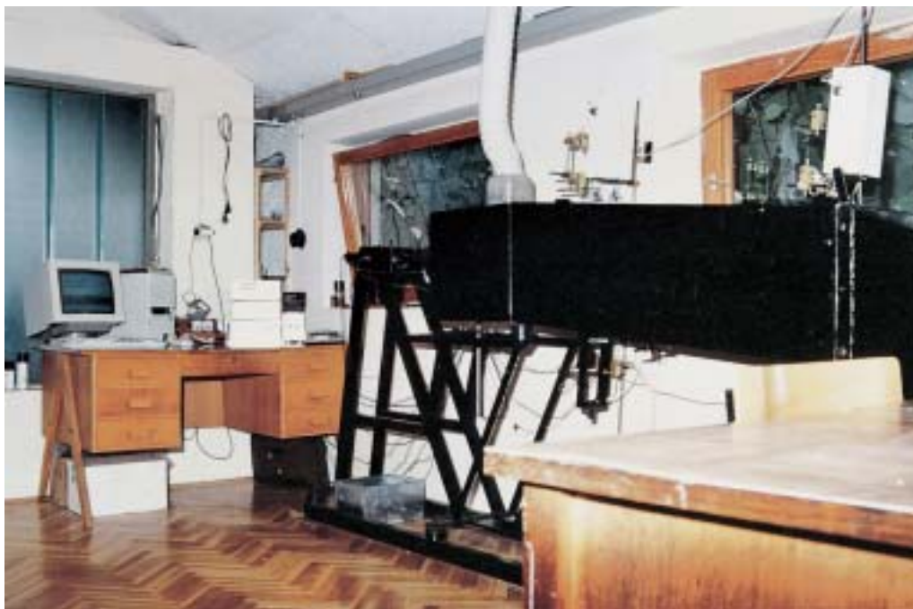
Doma razvit predor za kontrolo največjega pritiska in hitrosti krogelnega in šibrenega streliva. Zgoraj sta lepo vidni doma razviti laserski napravi za merjenje hitrosti. Tudi to je plod razvoja družine Bratina in slovenske miselnosti.
