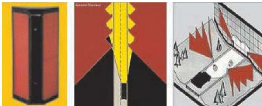
Slika 2: Prikaz reflektorja Swareflex (A) ter načina delovanja Swareflex optičnih ograj (B: skica tlorisa svetlobnega pasu, ustvarjenega s serijo reflektorjev; C: prostorski prikaz delovanja posameznega odsevnika) (vir: http://www.swareflex.com ).
