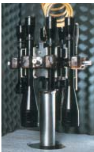
Redfieldov »destroyer« – naprava za preizkušanje vzdržljivosti strelnih daljnogledov na simulirane sunke moči 1,5-krat večje jakosti kot pri strelu s karabinko kalibra .375 H&H Mag.
