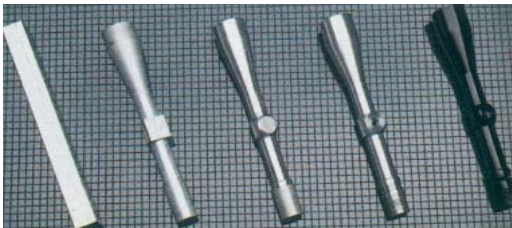
Monoblok konstrukcija sodobnega strelnega daljnogleda
