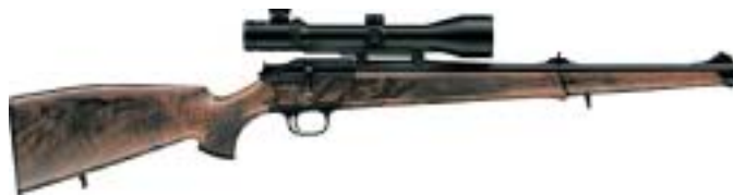
Luksuzna kratka lovska repetirka Blaser R 93 Stutzen; dolžina osmerokotne cevi je 52 cm, skupna dolžina puške je 97 cm, teža okrog 3 kg (odvisno od kalibra), kaliber 9,3 x 62 (tudi v kalibrih 7 x 64, .308 Win., .30 - 06 Spr. in 8 x 57 IS); opremljena je s kopitom s polnim in deljenim olesjem, neposrednim, izredno mehkim sprožilcem.
