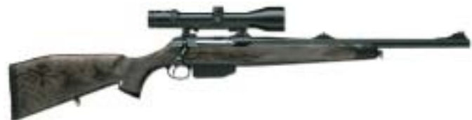
Specialna priročna lovska repetirka Sauer 202 Forest (ki jo tovarna priporoča kot specialno puško za lov na divje prašiče): dolžina cevi 51 cm (specialna, težja »Heavy Medium« izvedba, premer ustja cevi je 19 mm), zaklepišče je iz aluminijaste litine, skupna dolžina puške 102,5 cm, teža 3,4 kg, ima snemljiv petnabojni nabojnik s plastičnim dnom, kaliber 9,3 x 62 (tudi v kalibrih .308 Win., .30 - 06 Spr. in 8 x 57 IS), ročica zaklepa z okroglo bunko, kopito s svinjskim hrbtom in bavarsko ličnico; sprednji del kopita je oblikovan masivno (za zanesljiv in dober oprijem repetirke), kombiniran sprožilec z vzvratnim naprožilom.
