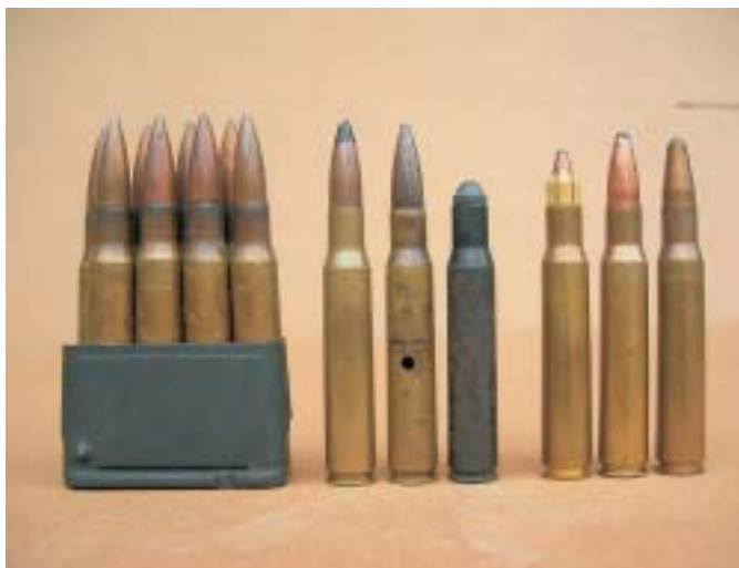
Naboji .30-06 Springfield (od leve): 1. – osemstrelni okvirček z ostrimi vojaškimi naboji za puško US M1 Garand; 2. – vojaški naboj s prebojno kroglo; 3. – vojaški šolski naboj (brez smodnika in netilke); 4. – vojaški naboj za sobno streljanje; 5. – v Severni Ameriki priljubljen naboj (za daljnosežne strele na gosi) s podkalibrskim izstrelkom Accelerator (v nekaterih članicah EU je prepovedan); 6. – naboj Igman Konjic z 11,7-gramsko kroglo (pred časom priljubljen oz. eden redkih nabojev, ki je dosegljiv slovenskim lovcem), 7. – naboj s kroglo ABC našega konstruktorja dr. Franceta Avčina iz generacije prvih poskusnih, neserijsko struženih krogel.
