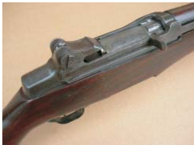
US M1 Garand. Polavtomatska osemstrelna naslednica repetirke 1903 Springfield, kalibra .30-06, Springfield. Osnovna orožje v 2. svetovni ter korejski vojni.
