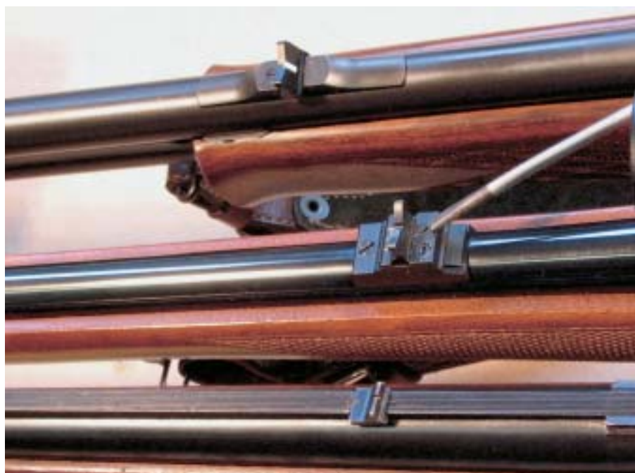
Zadnji merke ali vizir je lahko nastavljen po smeri in višini, tako kot na karabinki v sredini, ali pa samo po smeri, kot na obeh bokaricah ob straneh. V takem primeru je potrebno malo iznajdljivosti ali pa se lotimo mušice.
