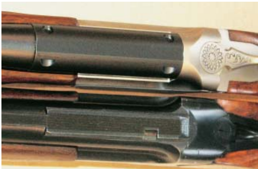
Vse sodobne serijsko izdelane prelamače z vsaj eno risano cevjo imajo že pripravljeno osnovo za montažo optičnih namerilnih priprav.
