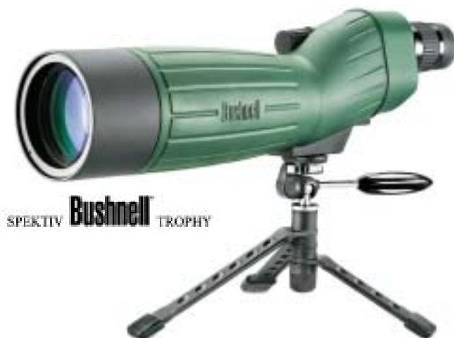
Trophy 20 – 60 x 65, model 782065, povečava: 20 – 60 x, objektiv: 65 (mm), vidno polje (m/1000 m): 27 (20 x) / 13,7 (60 x), izhodna zenica: 3,25 mm (20 x)/1,1 mm (60 x), teža: 567 g, dolžina: 322 mm
