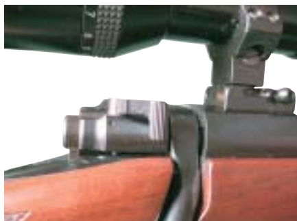
Varovalka z vodoravnim krilcem ameriške lovske repetirke Winchester Model 70 Classic Super Grade, kaliber .30-06 Springfield. Po načinu varovanja je enakovredna varovalki s krilcem sistema Mauser 98; njena prednost pa je, da je mogoče strelni daljnogled na zaklepišče montirati dovolj nizko.
