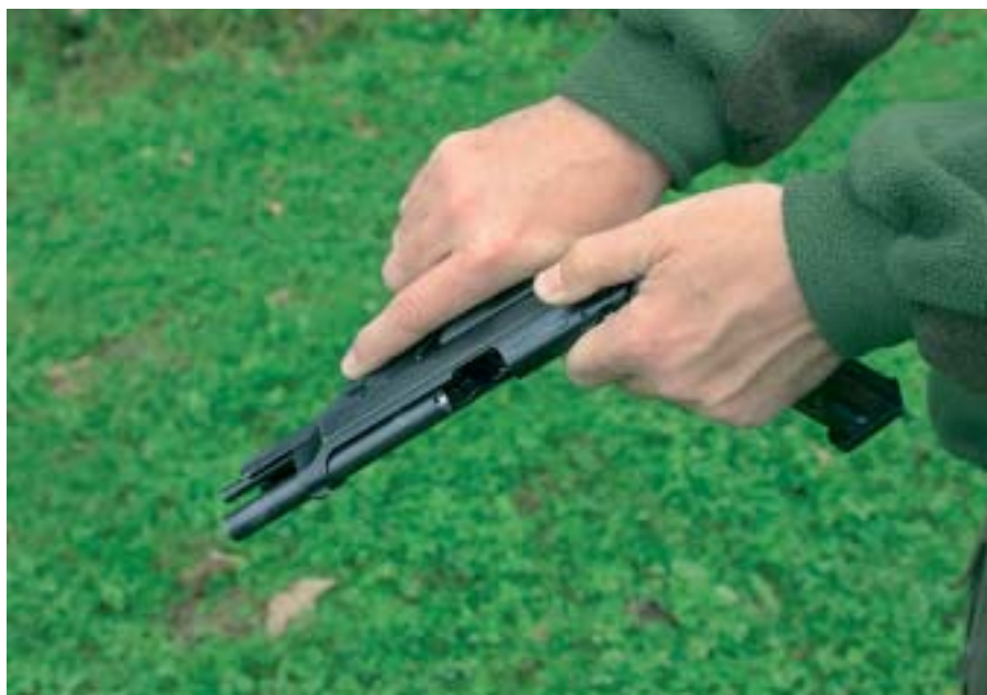
Preverjanje stanja orožja. Najprej izvlečemo nabojnik, nato potegnemo zaklep v zadnji položaj in preverimo ležišče naboja.
