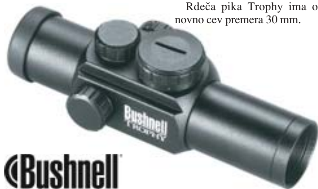
Model: 730132A, povečava: 1 x 28, namerilni ris: elektronski, rdeč, teža: 198,5 g, dolžina: 14 cm (brez podaljška), vidno polje: 22,6 m
