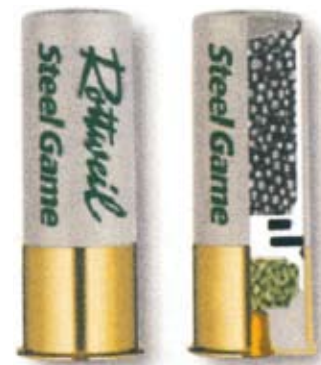
Slika 2: Naboj z jeklenimi šibrami. Zaradi povečane prostornine šibrov in smodnika ni zadostnega vmesnega blažilca, zato je ob strelu pritisk plinov v cevi zvišan.
