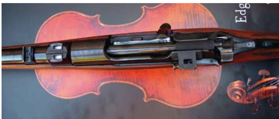
Slika 2: Prednji montažni nastavek za pritrditev strelnega daljnogleda je pritrjen na cev z lotnim spojem, zadnji del pa na levi strani zaklepišča. Poznavalci cenijo nepoškodovano glavo zaklepišča z ohranjenimi originalnimi vgraviranimi oznakami.
