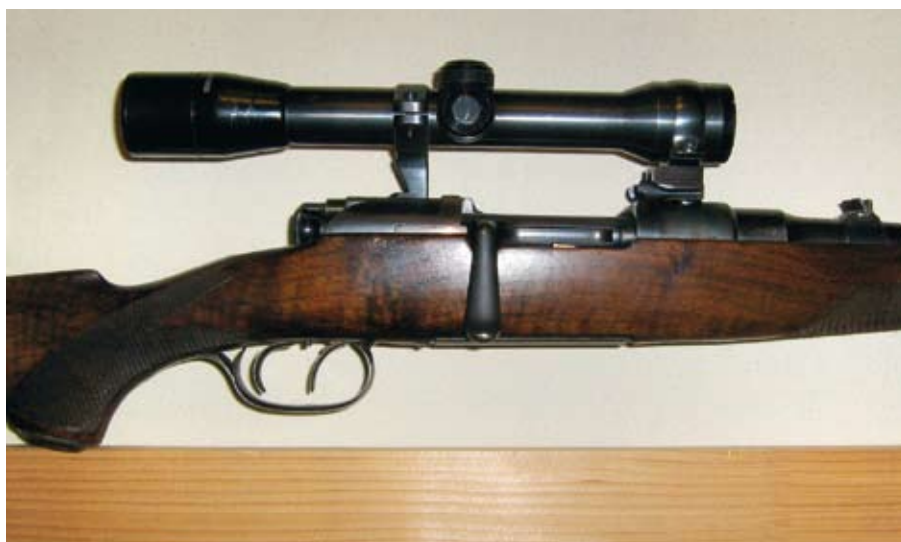
Slika 6: Kratka lovska repetirka Mannlicher-Schönauer (Jagd)stutzen (nem. oznaka) v kalibru 6,5 x 54 M.-Sch., izdelana pred prvo svetovno vojno, opremljena s strelnim daljnogledom s štirikratno povečavo. Še vedno je cenjena in še vedno v lovski rabi. Puška, prikazana na fotografiji, je družinska zapuščina nekdanjega znanega ljubljanskega puškarskega Albin Šifrerja in jo še vedno uporablja njegov vnuk Boris Leskovic.
