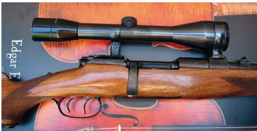
Slika 1: Repetirka Mannlicher-Schönauer, model NO, s pravokotno, navzdol zapognjeno ročico zaklepa, v kalibru 7 x 64, s približno 60 cm dolgo cevjo, s polovičnim kopitom, letnica izdelave 1963, sprožilec z nemškim naprožilom. Strelni daljnogled Kahles Helia Super, povečave 6 x 42 je na puško montiran s tritočkovno vtično suhlsko montažo. Natančnost dobro vzdrževane in ohranjene repetirke je še po pol stoletja zmerne lovske rabe primerljiva s sodobnimi repetirkami.
