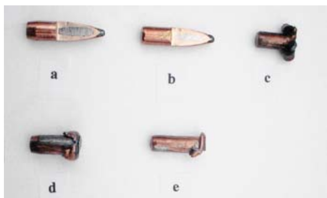
Lovska krogla PPU, imenovana Grom ; a – 8 mm v prerezu, b – 7 mm v prerezu, c – krogla 7 x 64, najdena v divjem prašču, d in e – 8 mm in 7 mm po preboju 30-cm sestavljenega bloka borovih desk (kal. 8 x 57 IS in 7 x 64).
