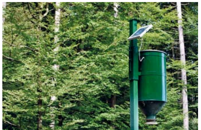
Bistveni sestavni del avtomatske krmilnice je premični krmni valj, izdelan iz sode, ki je pritrjen na drog. Njegov odpiralni mehanizem, ki ga poganja elektrika sončnih celic, je krmiljen elektronsko s pripravo, ki so jo inovativno izdelali lovci LD Novo mesto.
