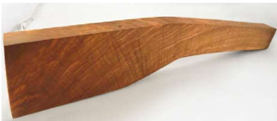
Surovec iz orehovine za izdelavo puškinega kopita repetirke; dolg je 890 mm, na spodnjem koncu 178 mm, debel 60 mm.
