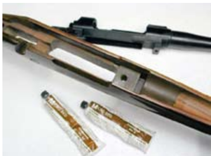
Kopito repetirke, ki je na notranji strani zalito z umetno maso. Notranji deli so zgledno obdelani.
