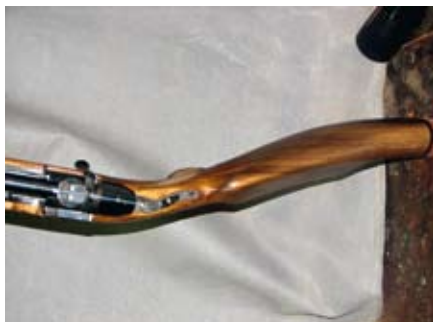
Zavito, po meri izdelano ortopedsko kopito za lovsko repetirko za strelca, ki kopito prislanja na desno ramo in meri z levim očesom. (Fotografija R. Flerin)
