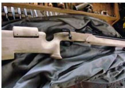
Po meri izdelano leseno kopito risanice za športno streljanje z nastavljivim hrbtom in dolgim strmim pištolskim ročajem (fotografija R. Flerin)
