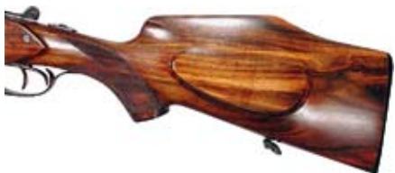
Naknadno dodelano kopito kombinirane lovske puške: zvišan hrbet kopita in nova ličnica
