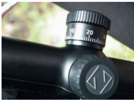
Slika 10. Na bobniču za višinske popravke strelnega daljnogleda C. Zeiss, ki je opremljen z merilnim križem ASV, je mogoče hitro in ponovljivo uravnjavati potrebne popravke lege zadetkov. Enemu razdelku (črtici) na bobniču ustreza en klik, ki na razdalji 100 m spremeni lego zadetkov za 1 cm.
