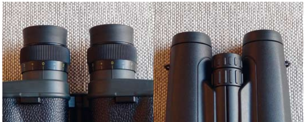
Slika 4: Na levi strani je daljnogled s prizmo Porro in sistemom ostrenja za vsako oko posebej, na desni pa daljnogled s prizmo Schmidt&Pechan in sredinskim gumbom za ostrenje.
