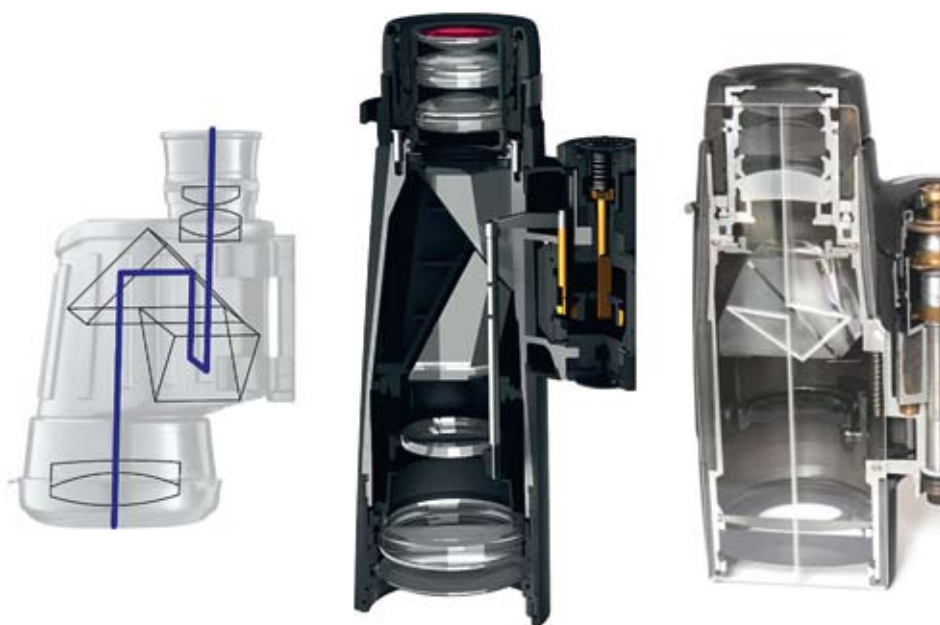
Slika 2: Na levi strani je prizma Porro, na sredini prizma Abbe-Koenig in na desni prizma Schmidt & Pechan. Iz slike je razvidno, zakaj so daljnogledi s prizmo Abbe-Koenig daljši od tistih s prizmo Schmidt-Pechan, čeprav obe spadata med »strešne« prizme.
