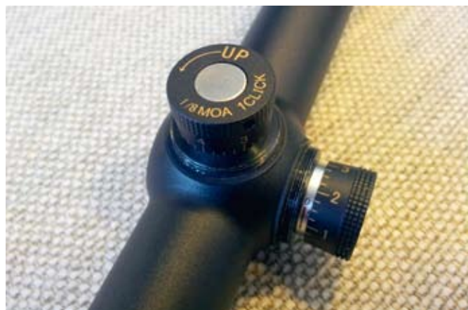
Slika 4: Z vrtenjem vertikalne kupole na strelnem daljnogledu v smeri, ki je označena z UP, se lega zadetkov na tarči dviga. Podobno velja za vodoravno kupolo, ki z vrtenjem v smeri, označeni z R, lego zadetkov premika v desno smer.
