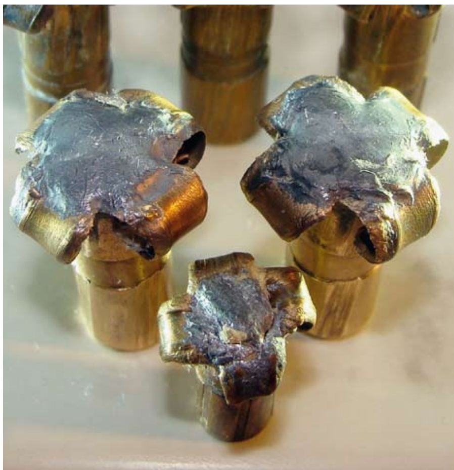
Sl. 10: Izstreljene in deformirane/razširjene krogle ABC v kalibru 7 mm ter 5,56 mm
