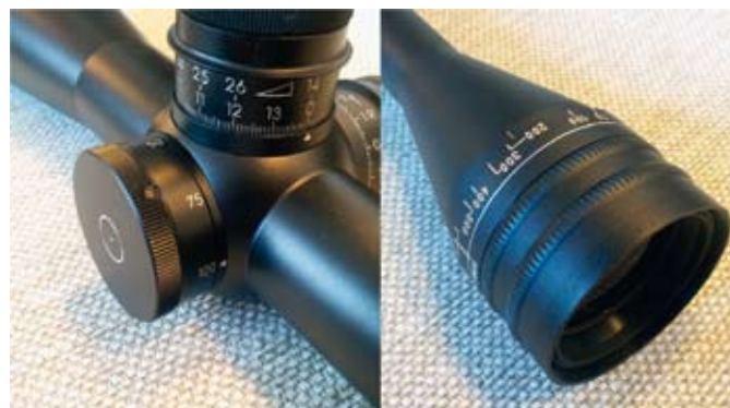
Slika 6: Strelni daljnogledi z večjimi povečavami omogočajo nastavljanje paralakse (goriščne razdalje tarče) s stranskim »fokusom« (na sliki levo) ali z nastavljivim obročem objektivna (na sliki desno).
