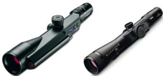
Slika 4: Na levi strani je strelni daljnogled z zunanjim laserskim merilnim sklopom (dodanim ob strani ohišja), na desni pa je strelni daljnogled, pri katerem je laserski namerilni del optične konstrukcije. V takšnih strelnih daljnogledih laserski žarki in vidna svetloba potujejo skozi iste leče.
