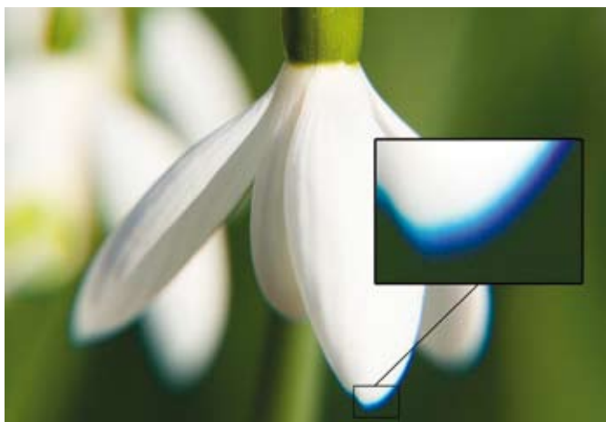
Slika 2: V okvirčku je povečan del slike, kjer je vidna težava s kromatsko aberacijo. Ker je rob med temnim in svetlim delom slike še dodatno popačen s kromatsko aberacijo, je slika takšnega daljnogleda neostra in s slabšim kontrastom. (Vir: www.wikimedia.org )
