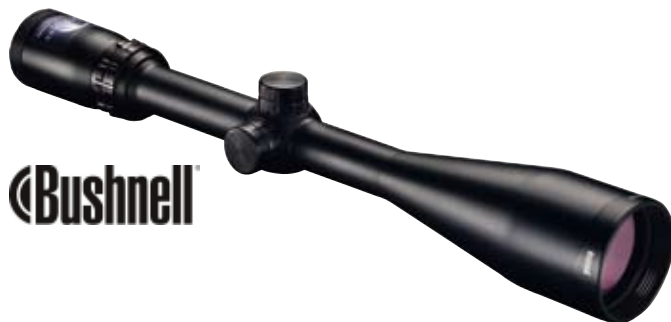
Model: 613950, povečava: 3–9 x 50, križ: multi-X, teža: 539 g, dolžina: 406 mm, vidno polje: 12 m (3 x)/4 m (9 x), izhodna zenica: 16 mm (3 x)/5,6 mm (9 x).
