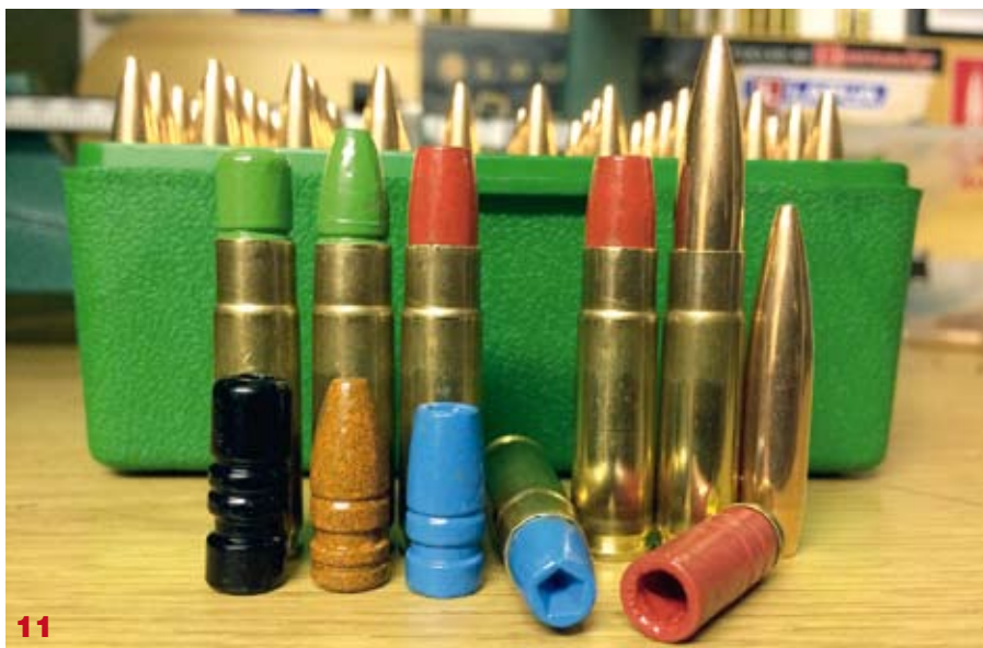
Naboji 300 AAC Blackout s svinčnimi krogli lastne izdelave
