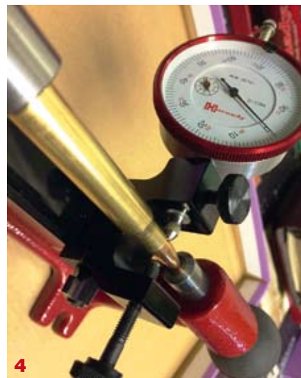
Merilnik koncentričnosti, Hornady
