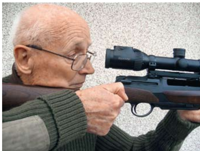
Repetirna ročica v zadnjem položaju ne moti strelca pri repetiranju s prilično puško, zapirac z vrtljivo glavo se giblje naprej-nazaj znotraj ohišja, ne štrli iz zaklepnega ohišja kot pri repetirkah z valjastim zaklepom in drugih premovlečnih repetirkah.
