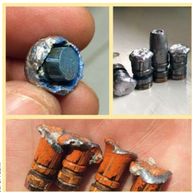
16: Preoblikovanje svinčenk pri majhnih hitrostih (300 m/s); različna trdota zlitine
