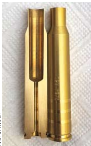
8: Prerez reducirnega tulca Samereier v kalibru 7 x 64
