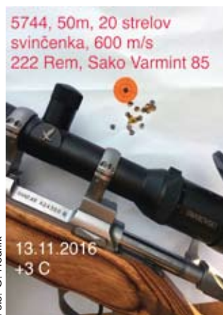
5: Dvajset reduciranih streliv iz puške, kal. .222 Rem., s smodnikom 5744 in svinčenkami
