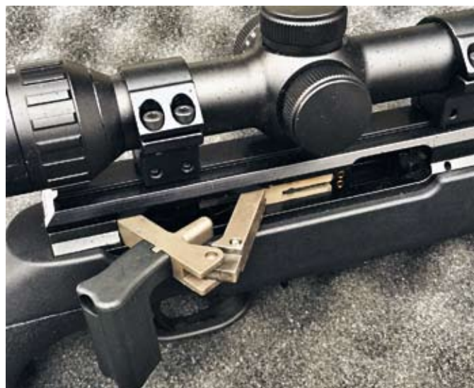
Odprt kolenasti zaklep pokaže enostavno konstrukcijo in natančnost izdelave.
