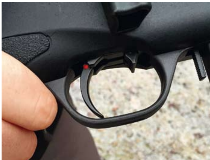
Varovalka je kar v braniku sprožilca in ko je puška zavarovana, je na njem vidna rdeča pika.
