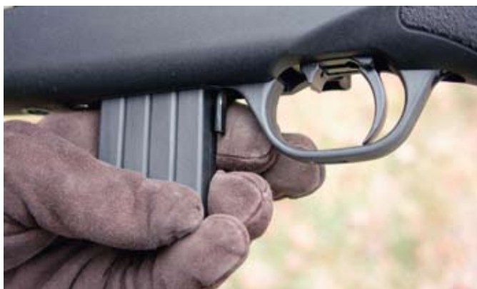
Utrjevalo desetstrelnega nabojnika; viden je tudi vzvod (zaklenjene) varovalke v braniku.
