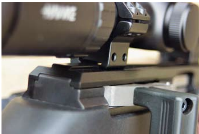
11-milimetrska montažna letev poteka po celotni dolžini ohišja in omogoča enostavno pritrnitev strelne optike.
