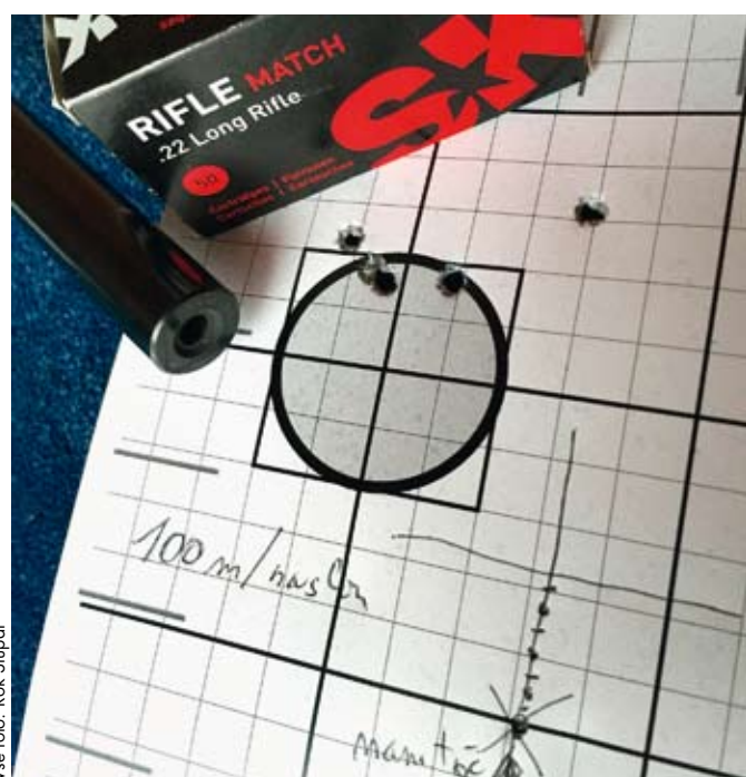
Petstrelna skupina na razdalji 100 metrov – merili smo s puško, pristreljeno na 50 metrov, s spodnjo piko mil-dot namerilnega zarisa (skica).
