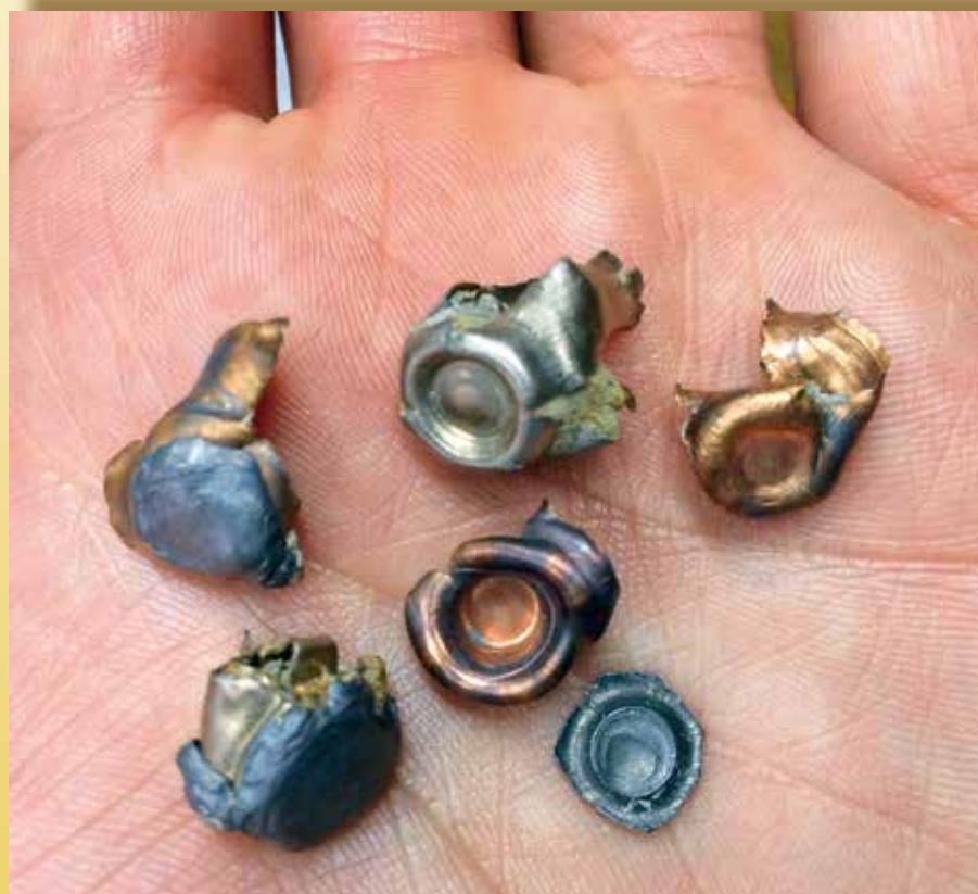
Slika 3: Krogle, mase 6 g in 8,2 g, po izstrelitvi v namočen papir
