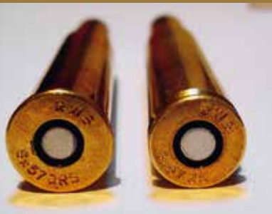
Slika 2: Črno označene netilke nabojev 8 x 57 IS in 8 x 57 IRS
