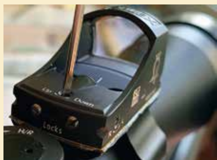
Slika 3: Umerjanje rdeče pike Noblex Sight C
