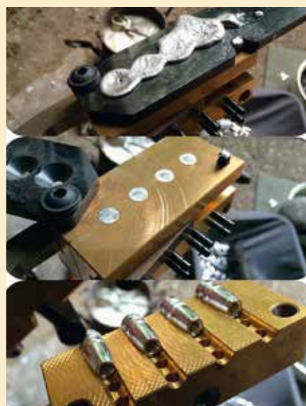
Faze ulivanja krogel: ulitje, odprtje rezilne ploščice in kalupa
