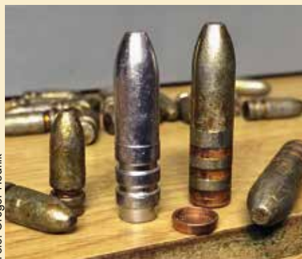
Svinčenke, 5,56 mm in 7 mm, premazane z aloksom in mastjo ter z nameščenim čepkom
