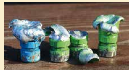
Slika 2: Preoblikovanje svinčenke MP 311-410, zelena, z 10 % kositra in globoko luknjo v vrhu, modra: čisti svinec in plitka luknja v vrhu
