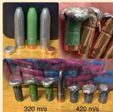
Slika 6: Krogla MP 311-235 AAC, preoblikovanje in primerjava s Hornady Sub-X 190 grs
