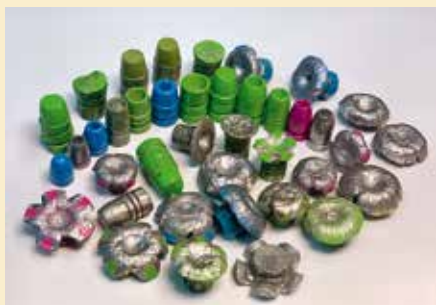
Slika 4: Razširne in nerazširne svinčenko v kalibrih 7,65 mm, 9 mm, .357 in .44 (.429)
