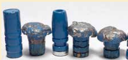
Slika 3: Idealno preoblikovanje svinčenk v kalibru .308 (7,82 mm)
