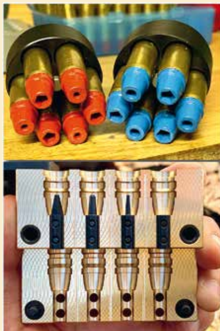
Slika 8: Kalup MP 432-256 za izdelavo krogel za kal. .44 Spl/.44 Magnum; napolnjeni naboji
