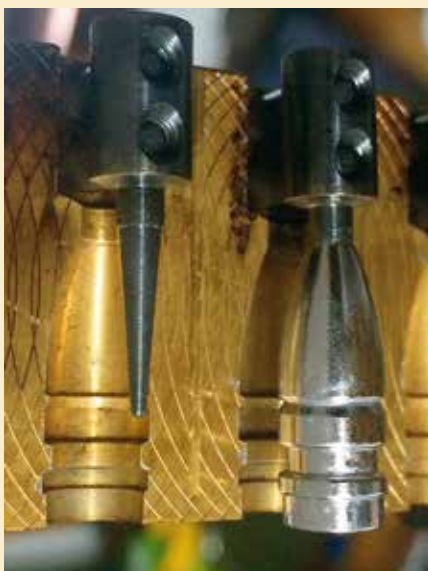
Slika 9: Kalup MP 311-410 za izdelavo 8,4 g lovske svinčenke z globoko luknjo v vrhu
