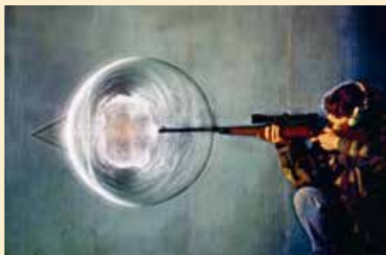
Slika 2: Udarni val ob strelu kalibra .30-06; krogla ima hitrost 2,5 macha.
