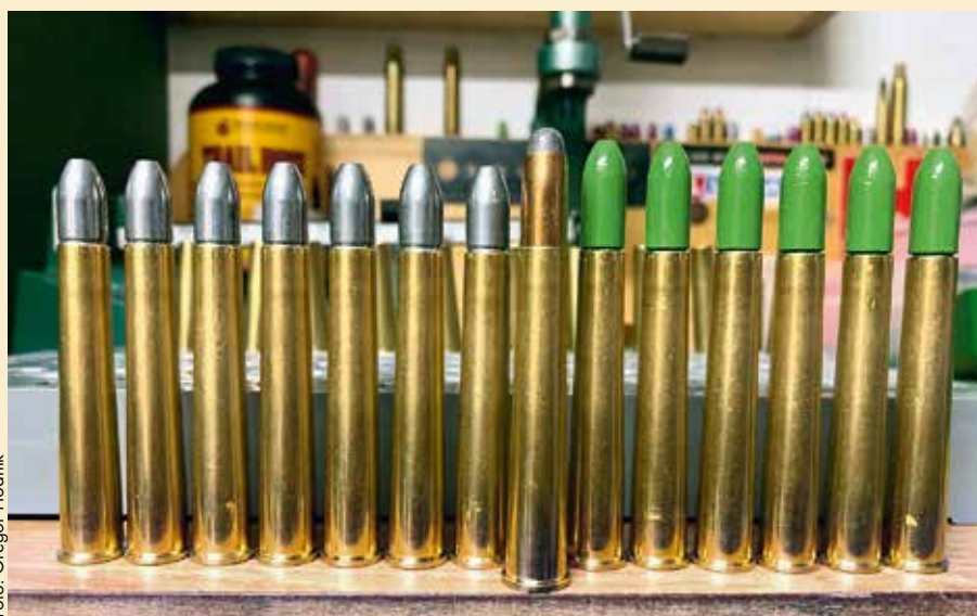
Napolnjeni naboji 8 x 58 R s svinčenkami in z oplašeno kroglo
