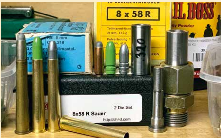
Matrice za polnjenje, krogle in kalibrator za svinčenke
