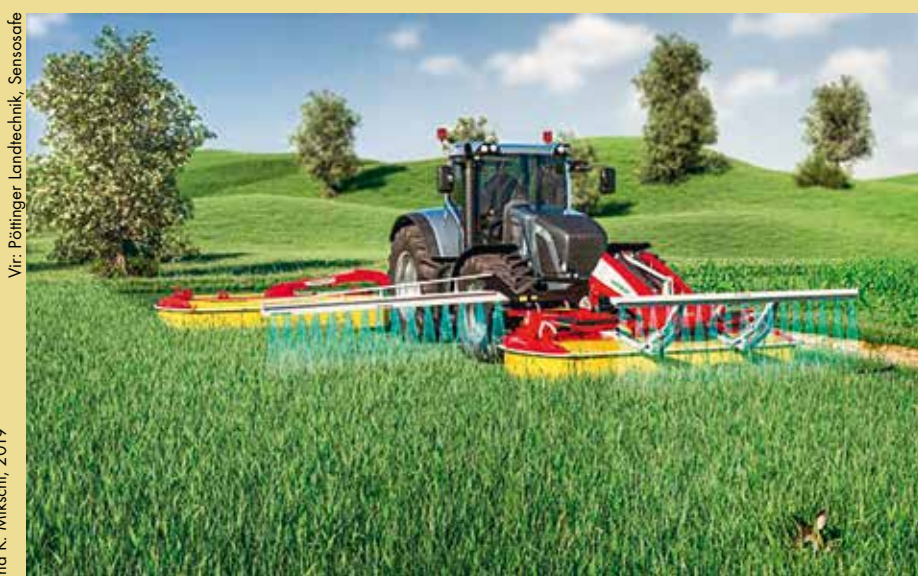
Slika 5: Naprava Pöttinger Landtechnik s senzorsko palico Sensasafe skrite prostoživeče živali v travniku zazna z optičnimi IR-senzorji in s sočasno nameščeno LED-osvetlitvijo. Naprava prepozna rjavo barvo in tudi zvočno opozori voznika, ki se odzove tako, da zavira traktor.
