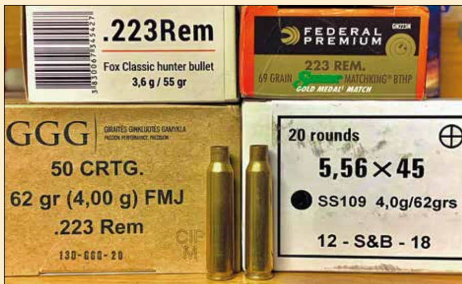
Slika 3: Strelivo in tulci .223 Remington in 5,56 x 45mm NATO se na zunaj ne razlikujejo.
