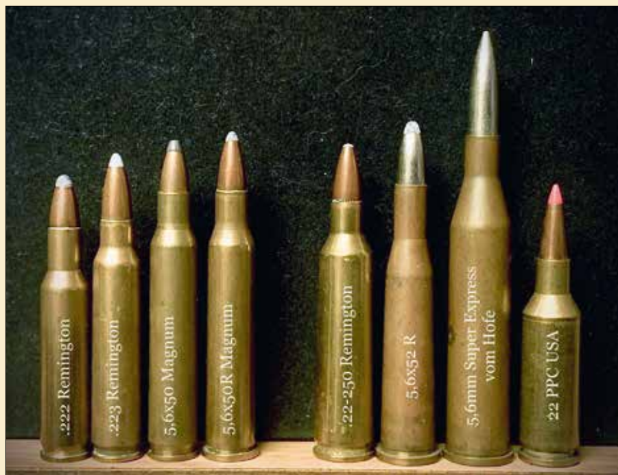
Slika 7: Primerjava nabojev .222 Remington , .223 Remington , 5,6 x 50 Magnum , 6 x 50 R Magnum , .22-250 Remington , 5,6 x 52 R in 5,6 mm SE vom Hofe
