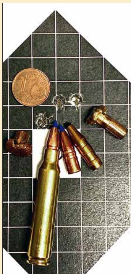
Slika 5: Zadeti z Barnes TTSX, 3,2 g, sledijo (L-D), deformirana krogla TTSX, naboj .223 Remington, krogla TTSX, krogla Classic Hunter (FOX Bullets) ter deformirana krogla ABC.
