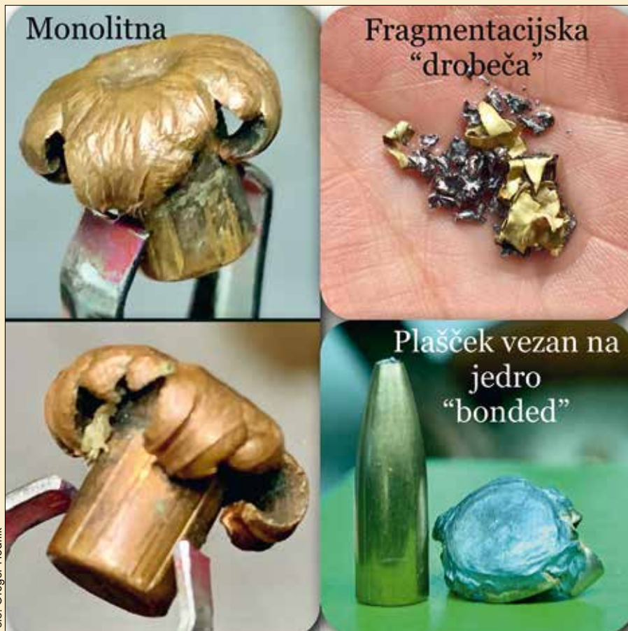
Slika 6: Preoblikovanje/delovanje konstrukcijsko različnih lovske krogel za .223 Remington
