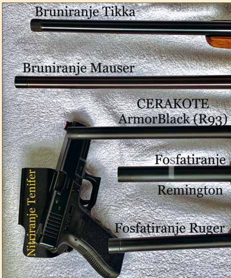
Primerjava različnih zaščit in premazov na ceveh risanic in na zaklepu G17
