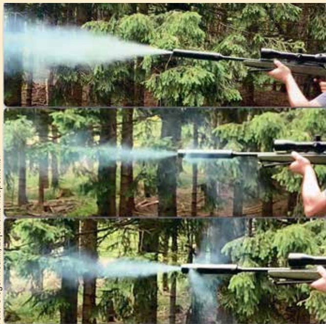
Slika 7: Primerjava odsuna in dviga ustja cevi z uporabo modula »kompensator odsuna«
