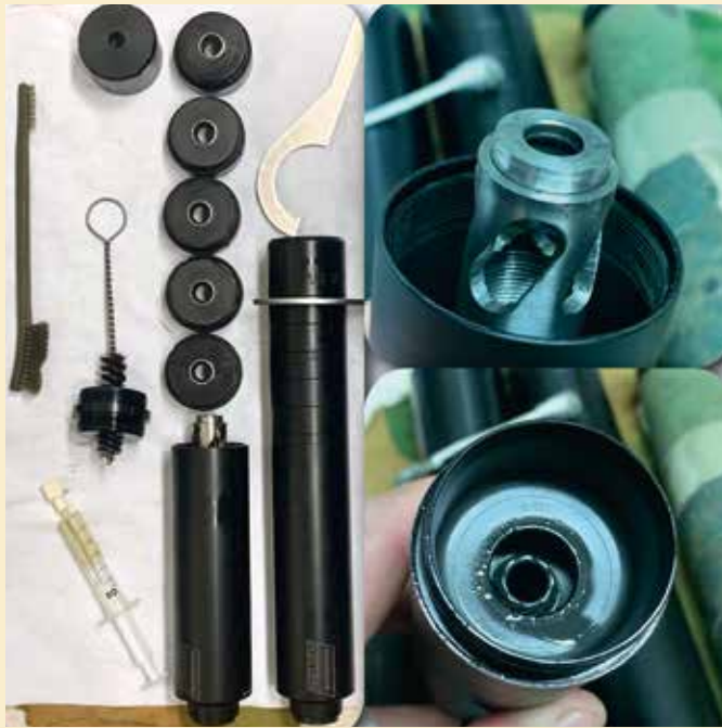
Slika 4: Notranja zgradba in razstavljanje dušilcev poka Sonic in Paradox
