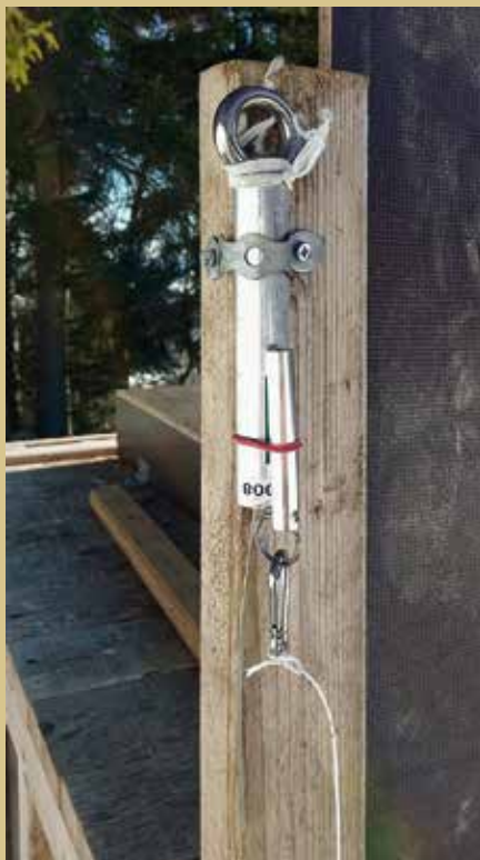
Slika 5: Nameščen alarmni sistem na aktivirani pasti. Signal se sproži, če drsna vrata ob zaprtju odstranijo magnet s senzorja na vratih.
