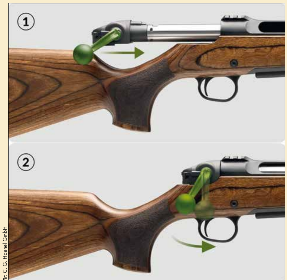
Prikaz zapiranja zaklepa in napenjanja udarne igle z ročico
