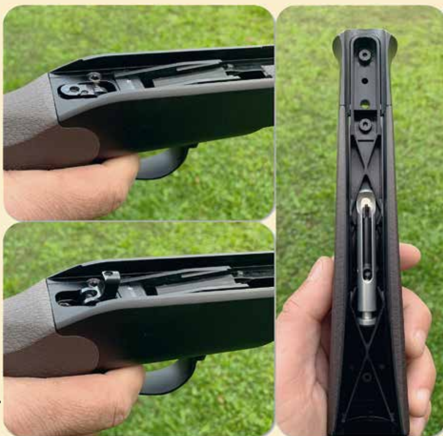
Slika 5: Nenapet in napet napenjalni vzvod in kopišček z orodjem za odstranitev cevi
