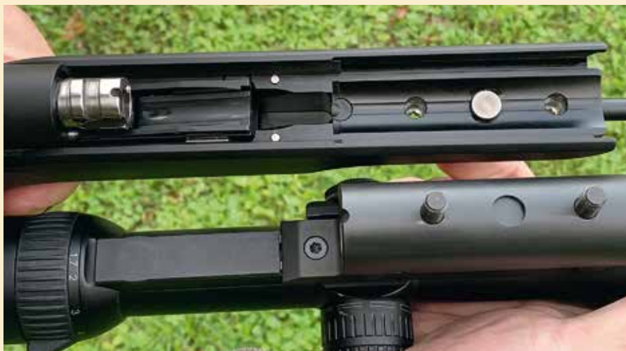
Slika 6: Zaklep, zaklepišče, cylinder in spodnji del cevi
