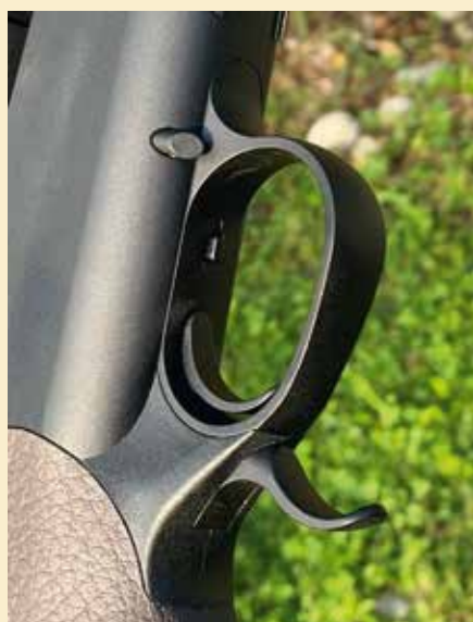
Slika 4: Spodnji del risanice z napenjalnim vzvodom, vzvodom za nastavitev proženja in gumbom za sprostitev nabojev iz nabojnika
