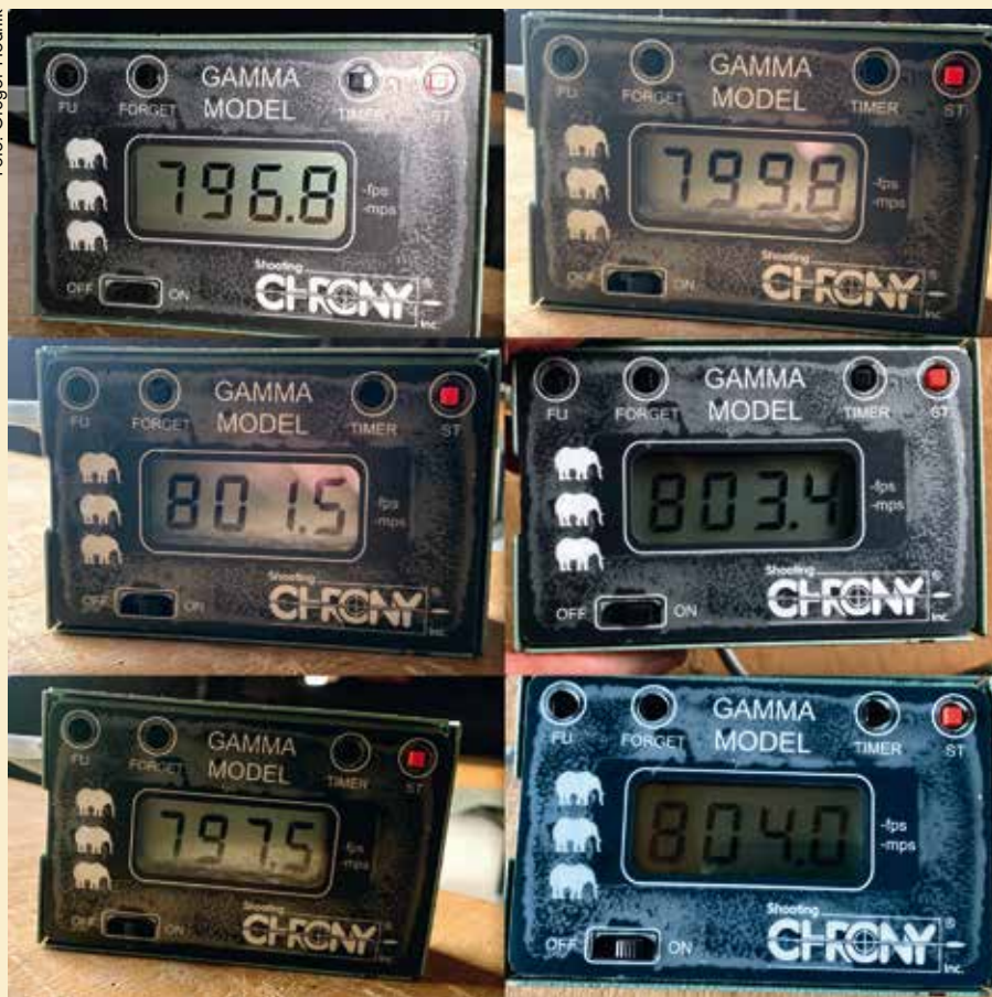
Izmerjene hitrosti streliva 8,5 x 55 Blaser s 13,6 g kroglo Norma SP
