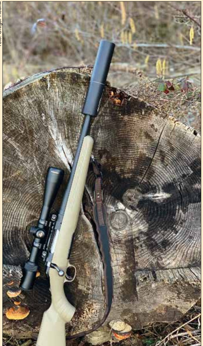
Slika 10: Dušilec Radien na kratki risanici (cev 40 cm) Ruger Ranch American, kal. 300 AAC BLK
