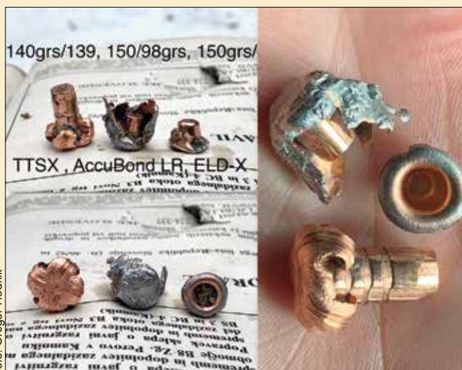
Sl. 4: Primerjalni obremenitveni test krogel: krogle TTSX, AccuBond LR in ELD-X
